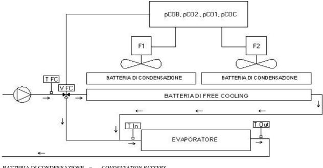
BATTERIA DI CONDENSAZIONE = BATTERIA DI FREE COOLING EVAPORATORE
