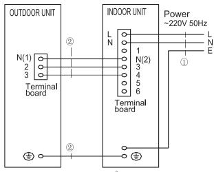
Note: 1) Power cable 3X2.5mm<sup>2</sup> 2) Intercnnecting cable 3X2m+1X1.5mm<sup>2</sup>
